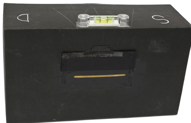
Macchina completa di otturatore e livello pronta per la ripresa
